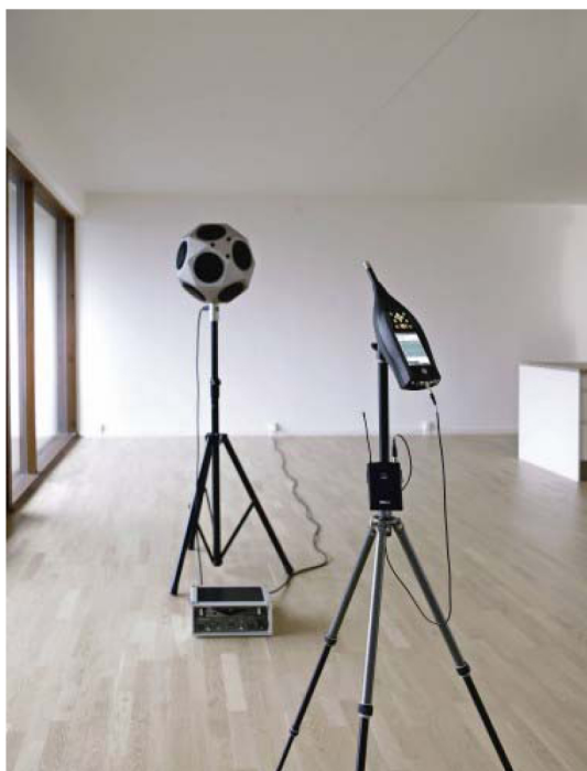
Mesures acoustiques logements
